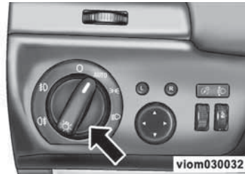
Рукоятка в положении "АУТО" (Автоматическое управление приборами освещения)
